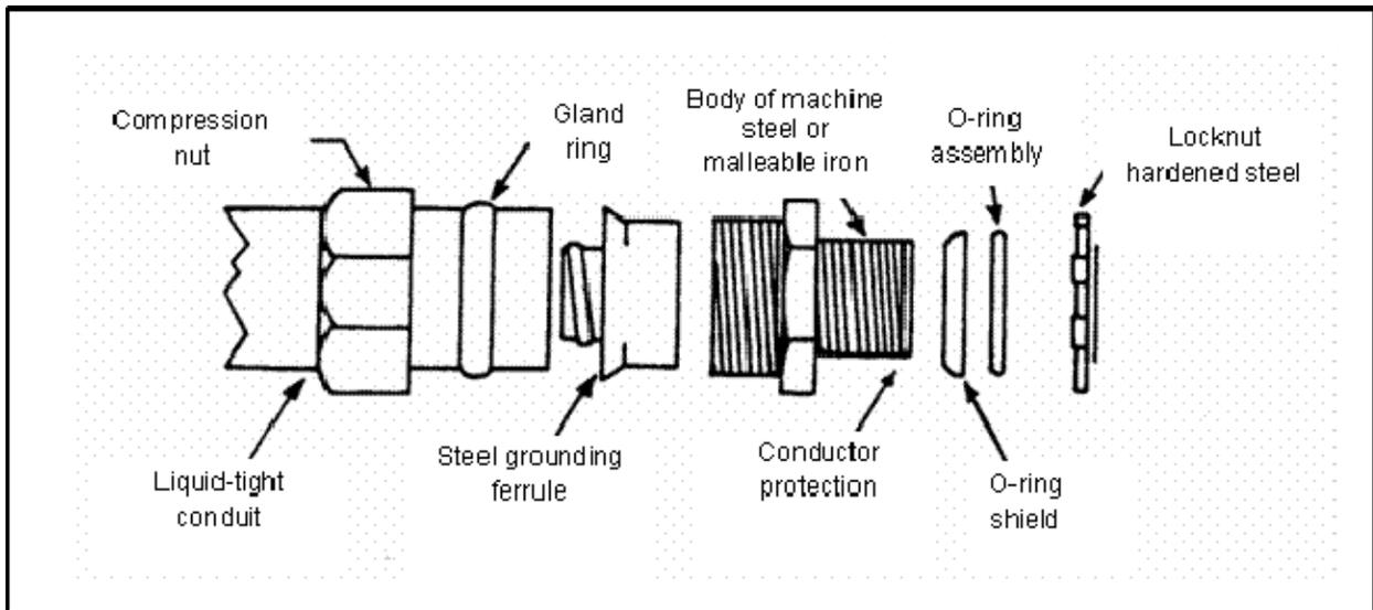
**Figure 4-11. Flexible metallic, liquid-tight conduit connector**
