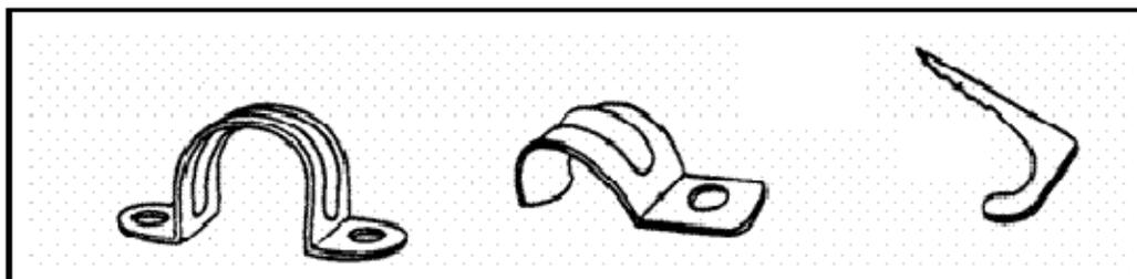
**Figure 4-14. Conduit supports**
