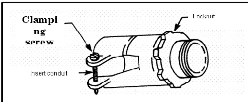
**Figure 4-10. Flexible metallic conduit connector**
